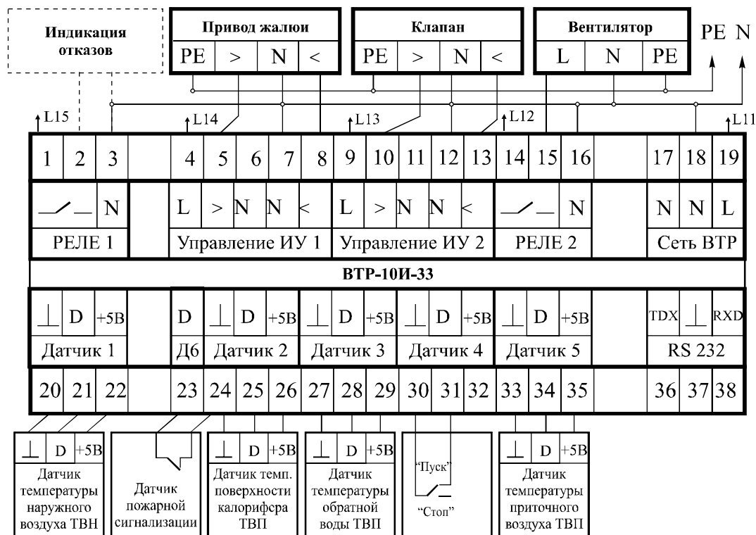
Схема подключения ВТР-10И (программа 33) в системе управления приточной вентиляцией
